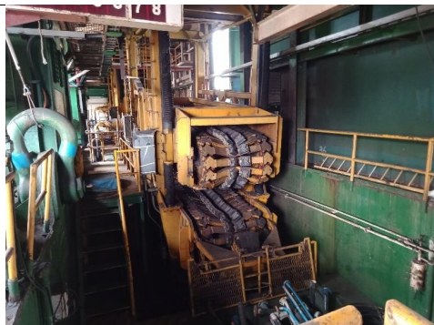
13) Pipelay tensioner.
